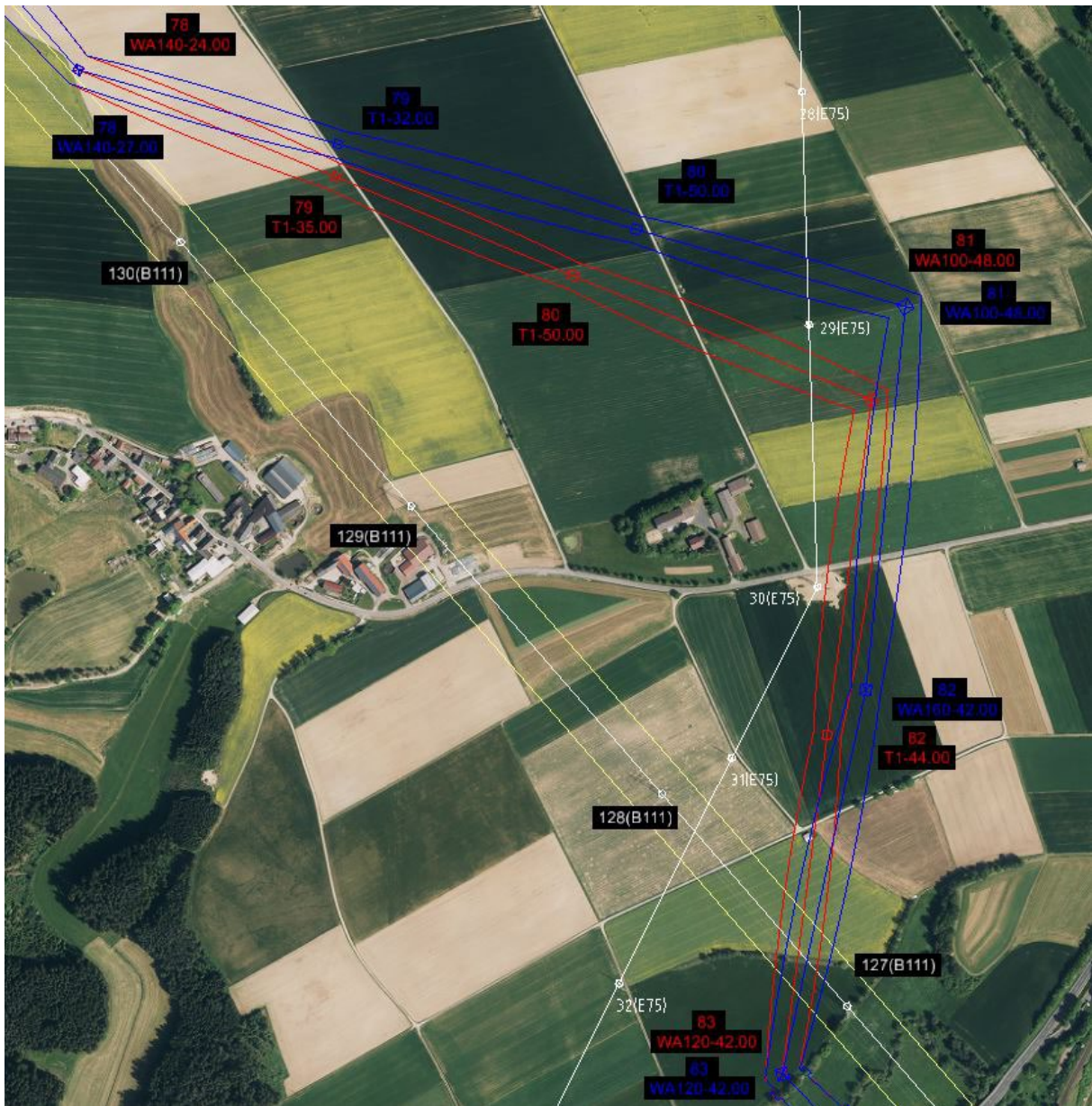
Abbildung 11: Umtrassierung im Bereich Korbersdorf von Mast 78 bis 83 (rot: Antrag; blau: Deckblatt; weiß: Bestandsleitung)
