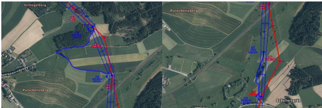
Abbildung 9: Umtrassierung im Bereich Schlegel (rot: Antrag, blau: Deckblatt)
