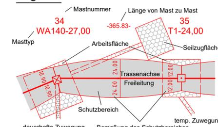
Masttyp: Mastnummer, Länge von Mast zu Mast, Seilzugfläche, Trassenachse, Freileitung, Schutzbereich, dauerhafte Zuwegung, Bemäufung des Schutzbereiches in Feldmitte / am Mast, temp. Zuwegung
