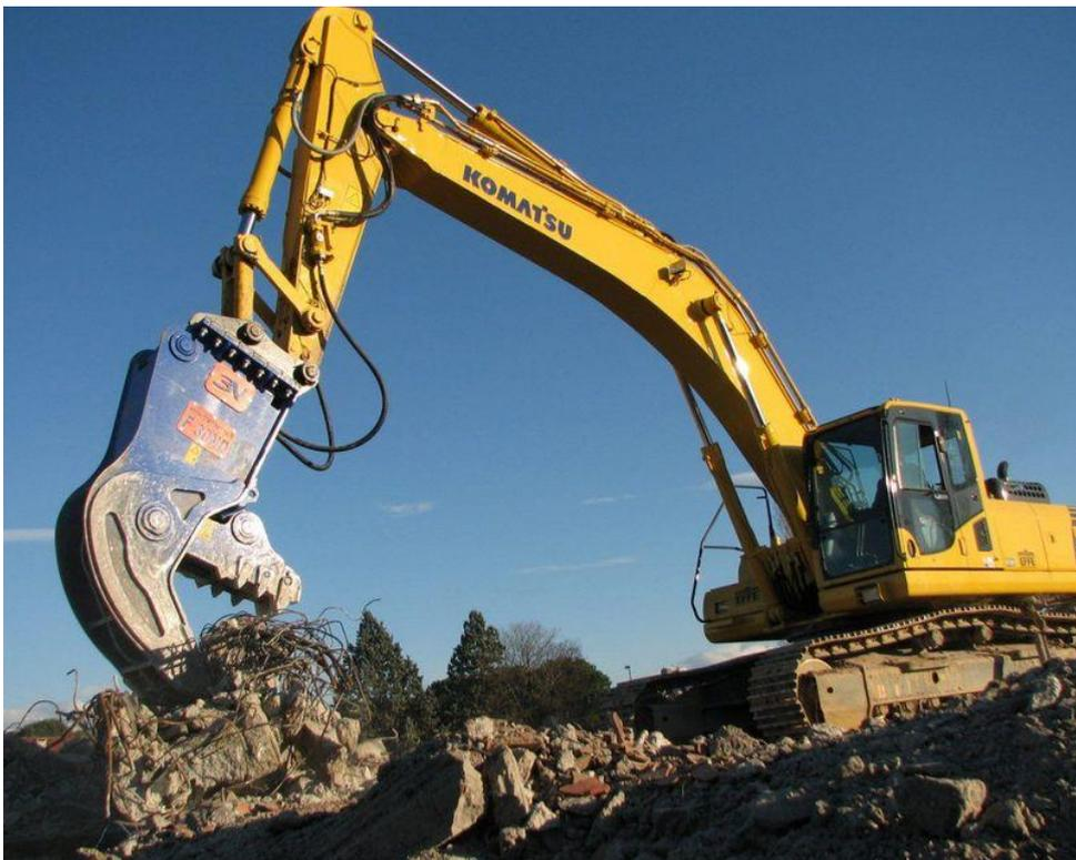
Abbildung 2.2: Bagger mit Abbruchzange (Pulverisierer)
